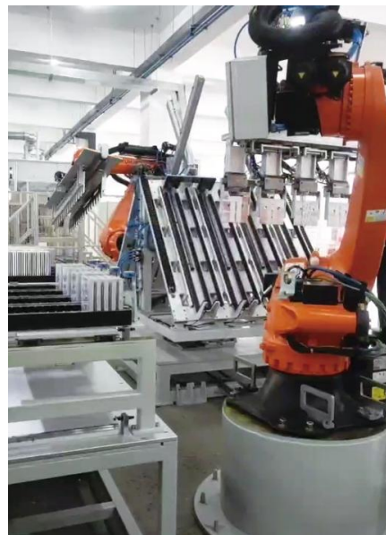
自动化产线，生产节拍达 到10个ppm
